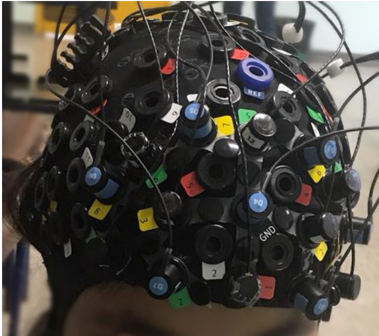
Figura 2. Equipamento de fNIRS. O instrumento é composto por uma touca com optodos (fontes e detectores de luz infravermelha), cujas localizações no escalpo são mapeadas de acordo com as áreas cerebrais a serem observadas.
