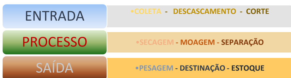
Figura 3 – Fluxo de processamento da fibra de coco
