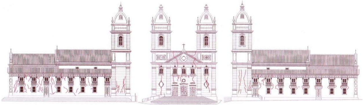
Figura 5 - Mapeamento das fissuras nas fachadas lateral esquerda, frontal e lateral direita Fonte: CORRÊA LYRA, 2006, p.64-65
