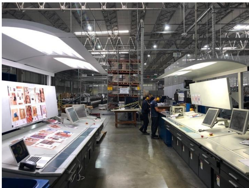
Figura 3. Máquina impressora com LED D50 Coralís (à esquerda) e luz Fluorescente comum (à direita)
